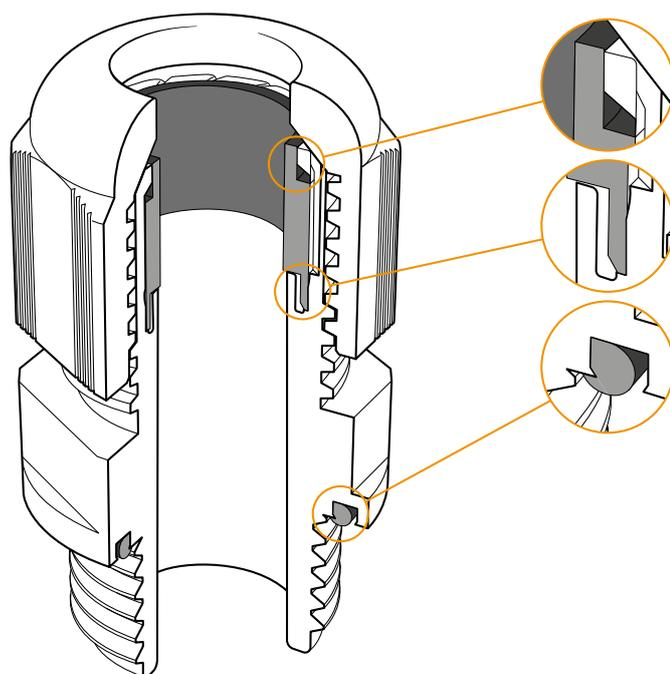
El diseño de la parte superior del cuerpo del prensaestopos retiene la junta y la mantiene en su posición.
