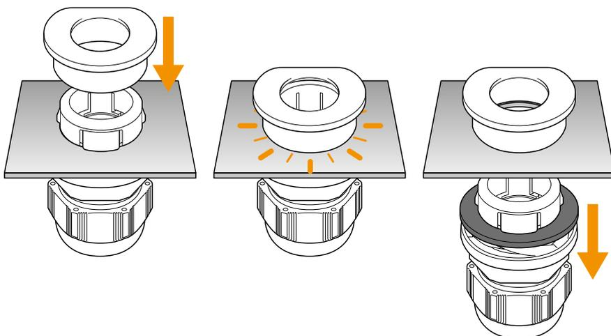
Retire el cable y empuje la herramienta BEX sobre la parte inferior del prensaestopas.
